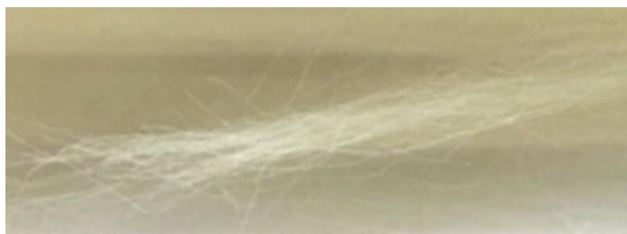
Рисунок 105. Керамические гранатовые волокна, модифицированные оксидом хрома из олигомера Cr-YAl-1
