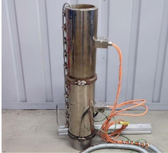
Рисунок 31 – Подфильерная сушильная камера
