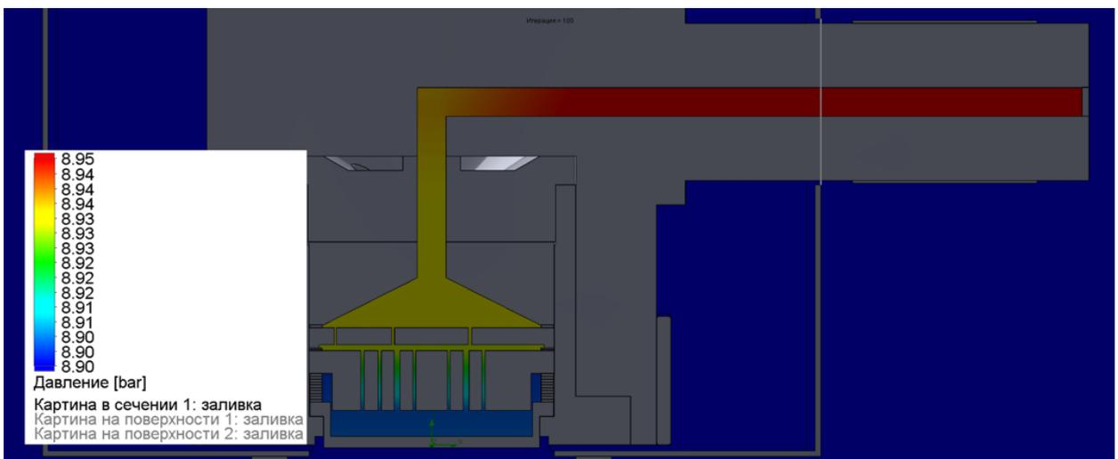
Рисунок 40 – Профиль давления в фильерном блоке
