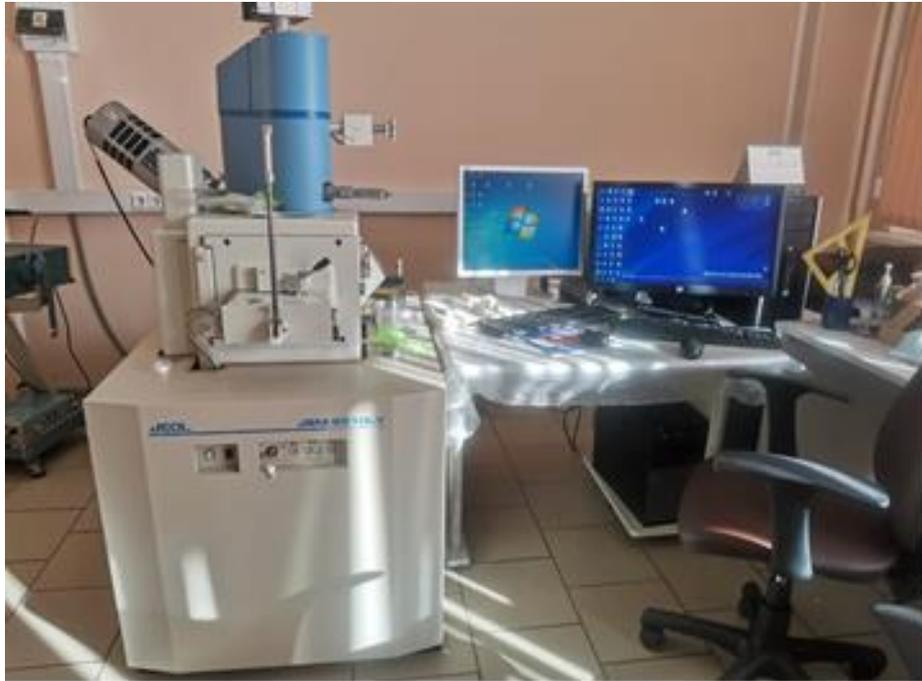
Рисунок 18 – Сканирующий электронный микроскоп Jeol JSM-6610 LV
