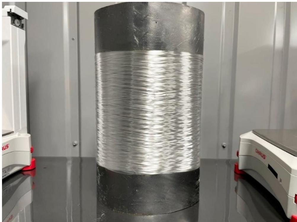
Рисунок 53 – Свежесформованные полимерные полисилазановые волокна
