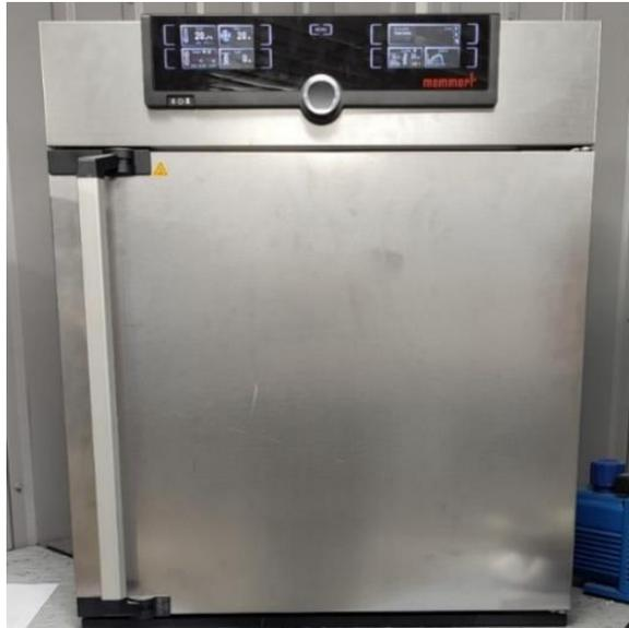
Рисунок 19 – Сушильный шкаф с программируемым нагревом Memmert
