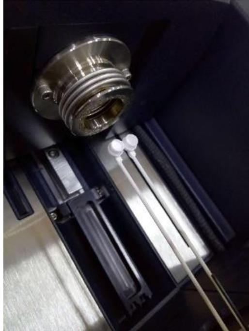
Рисунок 13 – Навеска порошка полисилазана в тигле перед загрузкой в прибор TA Instruments SDT650
