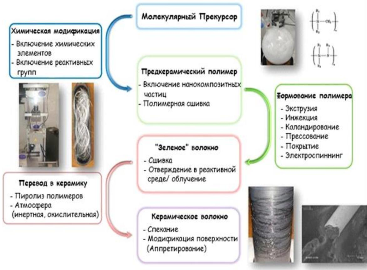
Рисунок 1 – Технологическая схема получения керамических волокон PDC-методом [43]
