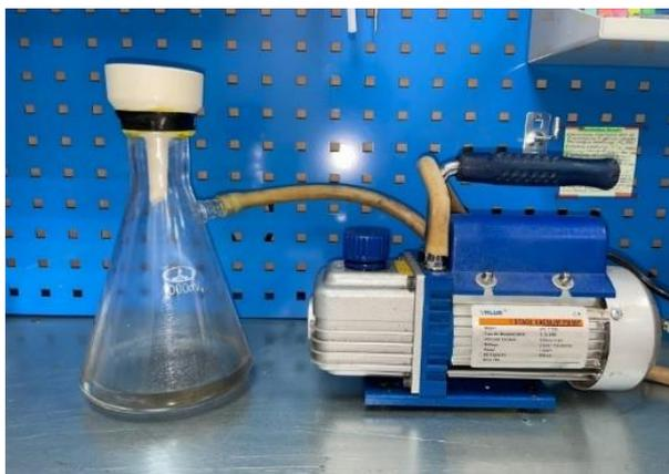
Рисунок 10 – Система вакуумной фильтрации
