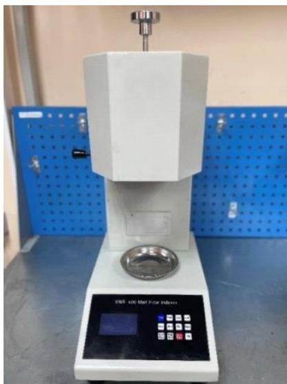
Рисунок 8 – Пластометр XNR-400 Melt Flow Indexer
