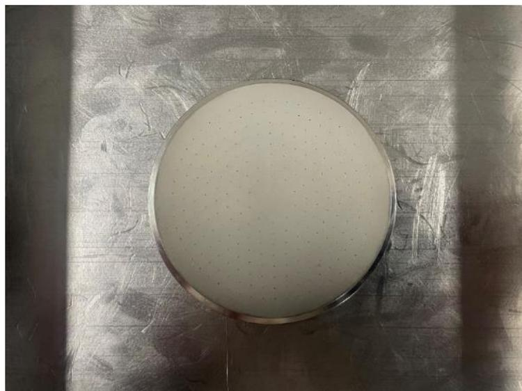
Рисунок 30 – Фильера для расплавного формования на 250 отверстий
