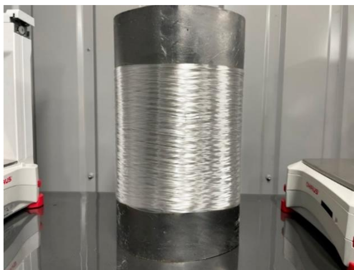
Рисунок 9 – Свежеформованные полимерные полисилазановые волокна
