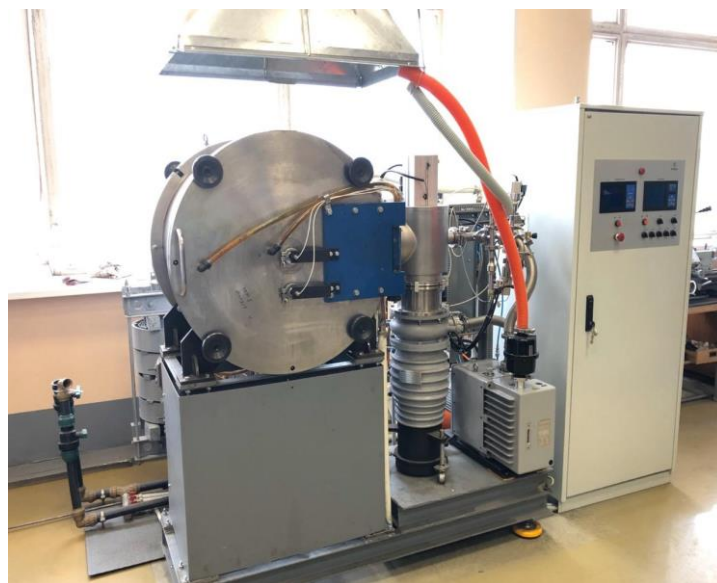
Рисунок 20 – Высокотемпературная печь СНВЭ 3.3.3/22ИЗ
