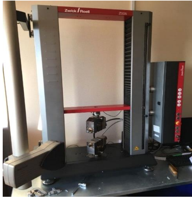
Рисунок 15 – Испытательная машина Zwick/Roell Z005 kN ProLine для определения предела прочности и относительного удлинения при растяжении
