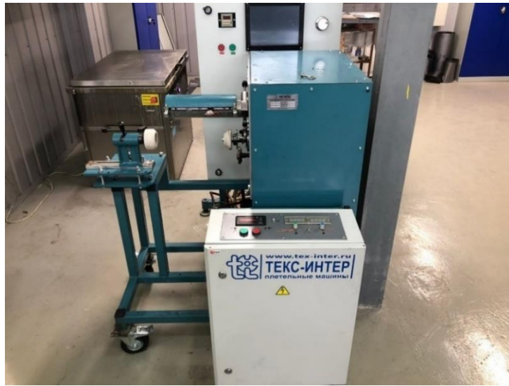
Рисунок 39 – Устройство вытяжки и приёма нитей установки расплавного формования
