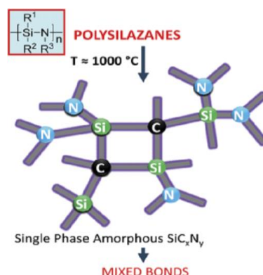
Рисунок 1.4 – Микроструктура аморфной керамики SiCN, полученной из полисилазанов [1]
