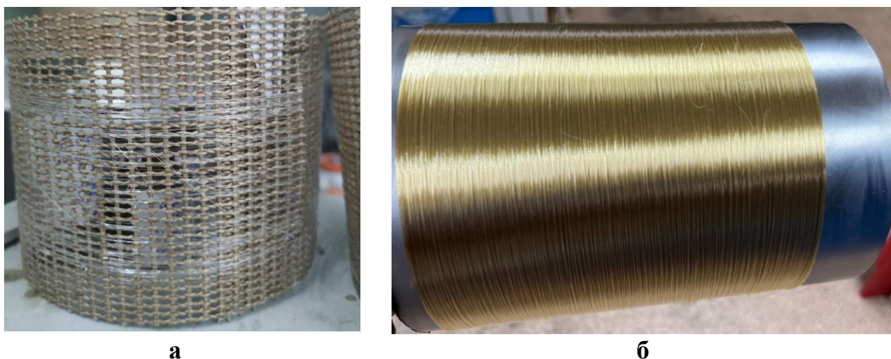
Рисунок 3.58 – Фотография сформованных волокон на основе ВООС-Ті: а – ручным формованием; б – формованием в экструдере в АО «Композит».
