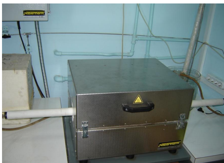
1 – блок управления печи 2 – трубчатая печь ( d_{\text{тр}}=50 мм, t_{\text{max}}= 1100 °С)
