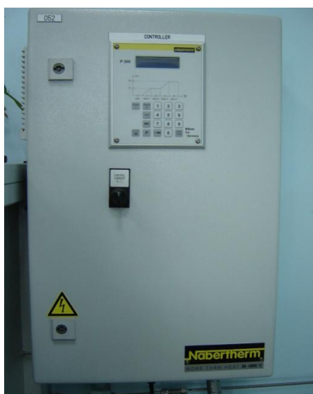
1 – блок управления печи 2 – трубчатая печь ( d_{\text{тр}}=50 мм, t_{\text{max}}= 1100 °С)
