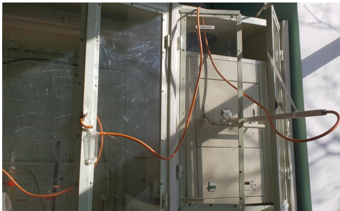
Рисунок 2.17 – Фото модернизированной электропечи сопротивления СНОЛ 12/16
