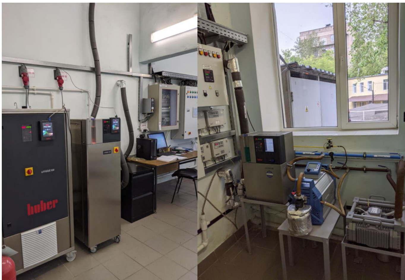
Рисунок 26 – Термостатирующее и насосное оборудование установки получения декаборана
