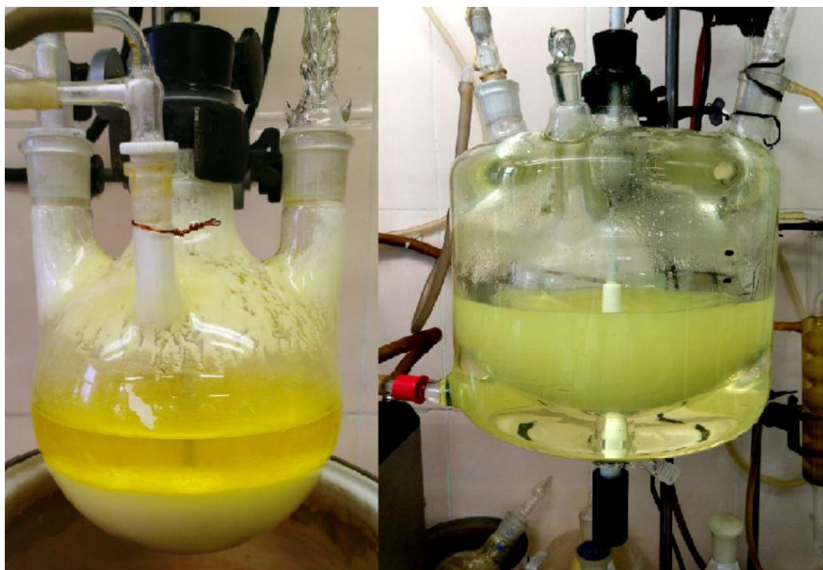
Рисунок 15 – Реакторы для синтеза толуольного раствора декаборана различного объёма (слева- объём 2 литра, справа – 4 литра).
