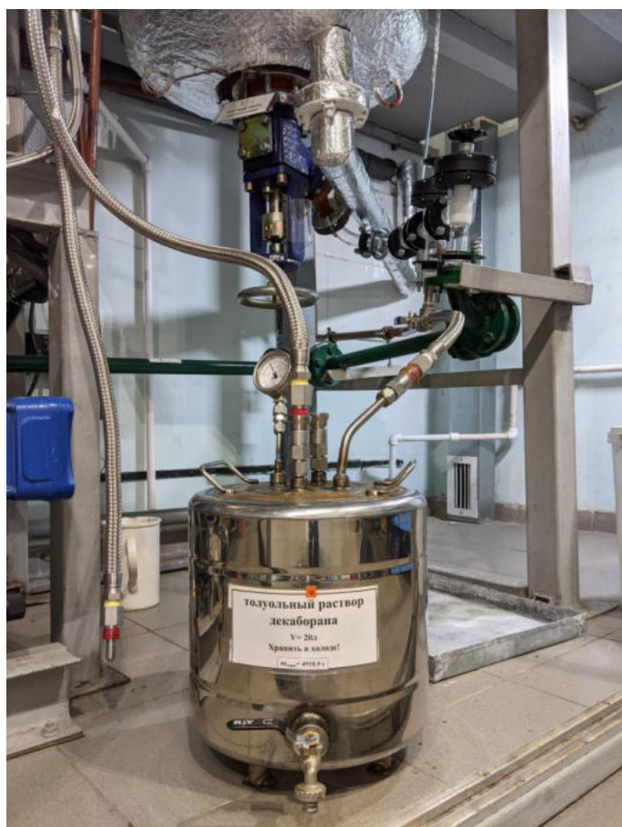
Рисунок 26 – Термостатирующее и насосное оборудование установки получения декаборана
