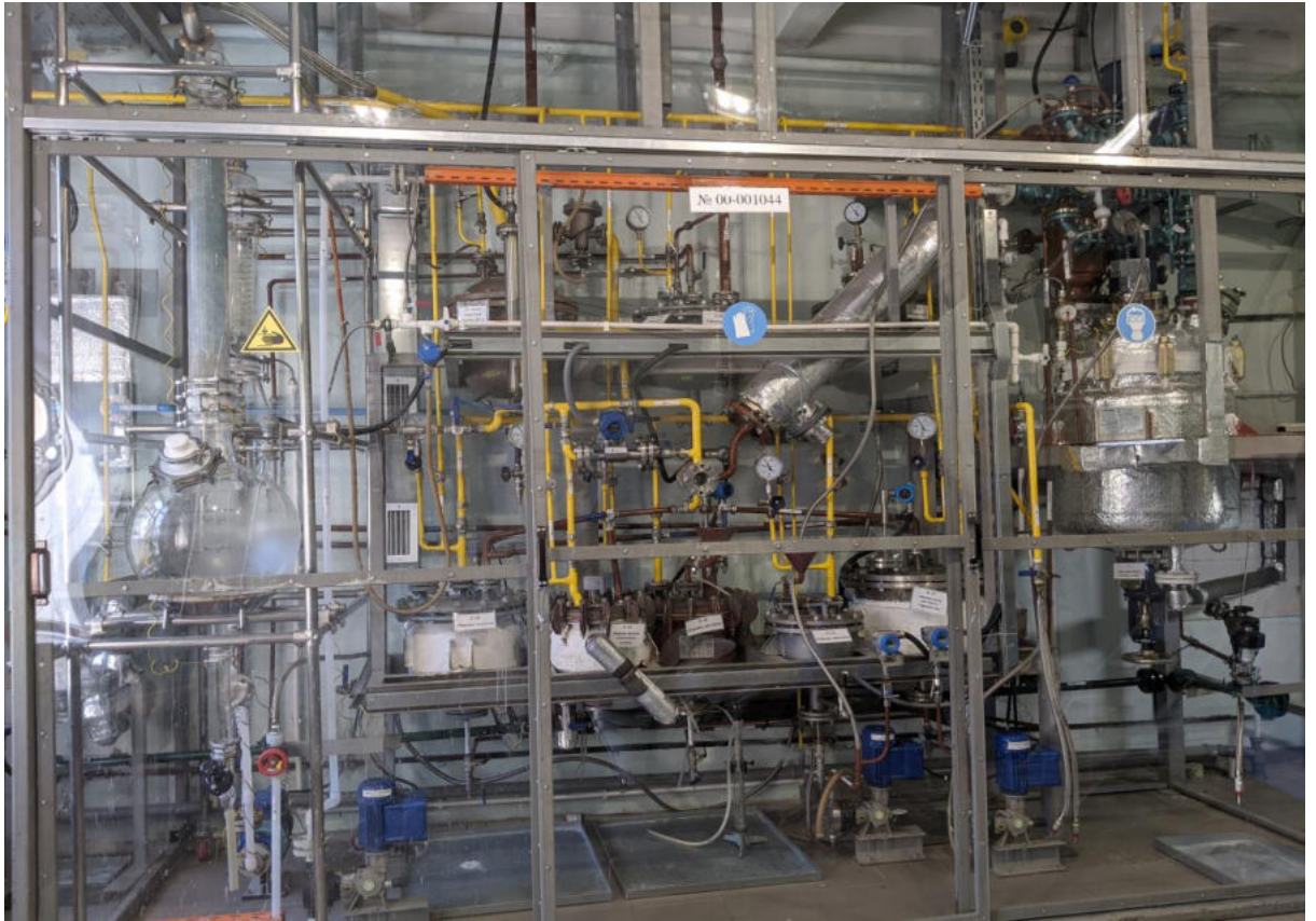
Рисунок 17 – Опытная установка по получению толуольного раствора декаборана с реактором объёмом 216 литров
