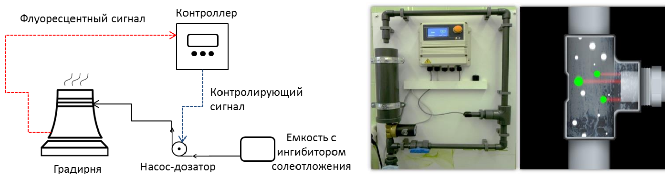
Рисунок 1 – Система автоматического контроля флуоресцентного ингибитора (слева) и принцип работы датчика (справа)
