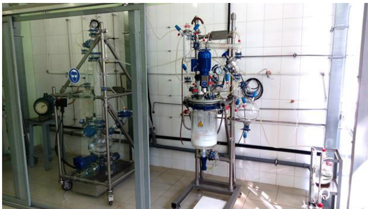
Рисунок 10 – Пилотная установка по получению толуольного раствора декаборана объёмом 10 литров
